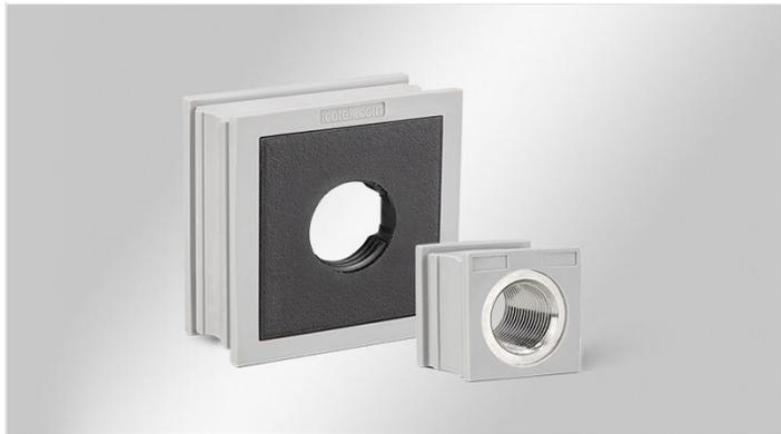
Die Adaptertülle AT-M ist auf Basis einer KT Kabeltülle groß aufgebaut. In dieser Tülle ist ein Polyamidkorpus integriert. Verfügbar ist die AT-M mit Innengewinde M12 x 1.0, M16 x 1.5, M20 x 1.5 und M25 x 1.5.
